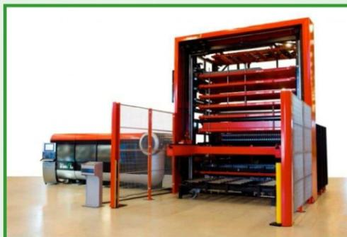
La **M.F.Z.** srl dispone della macchina per il taglio lamiere. **LASER AMADA LC 3015 F1 NT AF4000**. campo di lavoro da 3000×1500, completo di magazzino.
